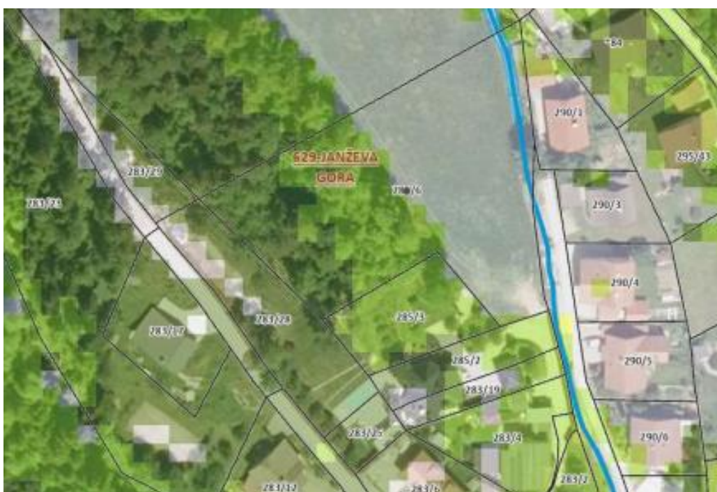
Izsek iz Atlasa voda Opozorilna karta verjetnosti pojavljanj drobirskih tokov: majhna do zelo majhna stopnja.
